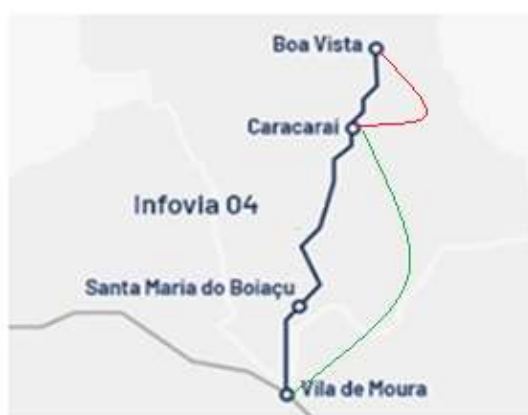
Figura 2 – Parte da Infovia 04 entre Vila do Moura (AM) a Boa Vista (RR)), com trechos subfluvial (verde) e terrestre (vermelho)
